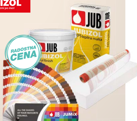
Fasada Jubizol 039 17 cm z belim zaključnim slojem Sestava: fasadna plošča eps W039 17 cm • eps lepilna malta • mrežica 145 g • vmesni premaz Unigrund • akrilni dekorativni omet Acryl Finish S 1,5 mm beli
