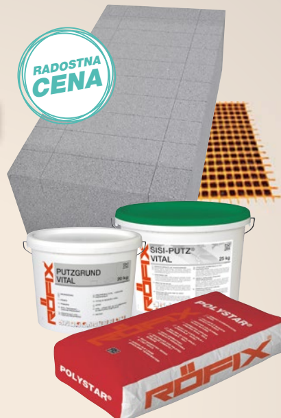
Fasada Röfix Light EPS 031 13,5 cm z zaključnim slojem • sestava: fasadna plošča Röfix Relax eps 031 13,5 cm, Röfix Polystar lepilna malta, Röfix P50 armirna mreža, Röfix predpremaz Vital, zaključni omet Röfix SISI / silikonsko- silikatni 1,5 mm beli • cena za m 2 • na voljo po predhodnem naročilu
